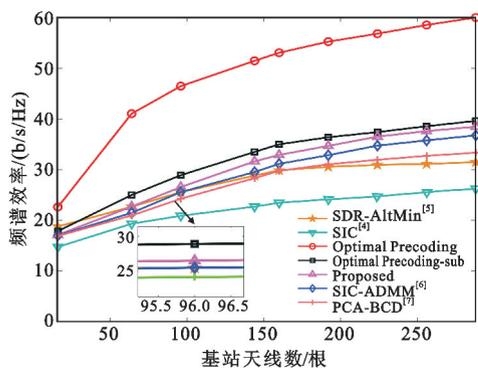
图3 系统频谱效率与基站天线数目的关系
