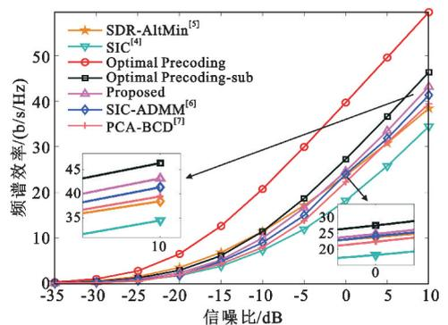
图 2 系统频谱效率与信噪比的关系
