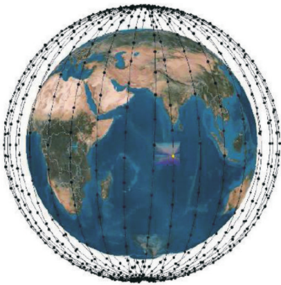
图 2 OneWeb 系统星座模式 Fig. 2 Constellation pattern of OneWeb system
