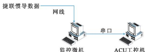
图1 捷联惯导设备连接关系图
