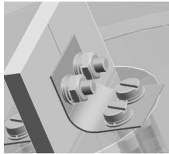
图 4 辐射面馈点连接结构
