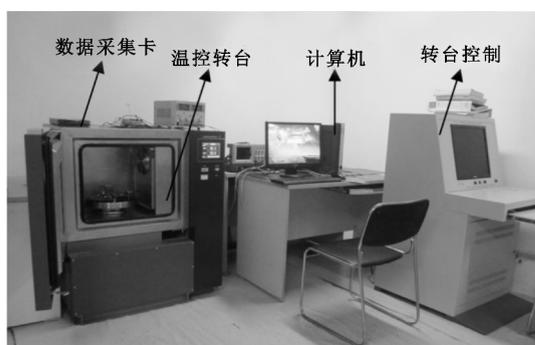
图 4 MEMS 陀螺仪测试平台
