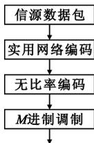
图 2 信源节点的编码流程图
