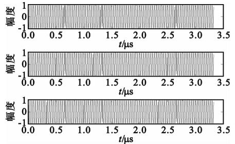
图 1 TPM 信号波形图(从上至下的调制码元突变时刻依次为脉宽的 19/20、15/20、10/20 倍)
