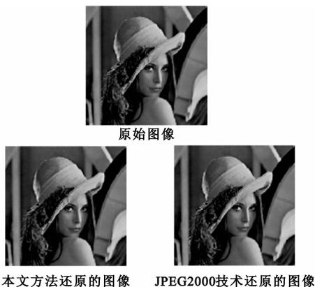
图4 无重叠分块压缩的还原效果
