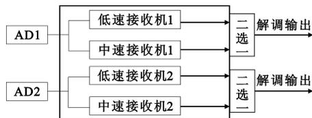
图 2 接收机结构框图
