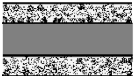
图3 高介电常数芯层的B夹层结构
