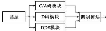
图1 GPS信号调制原理图
