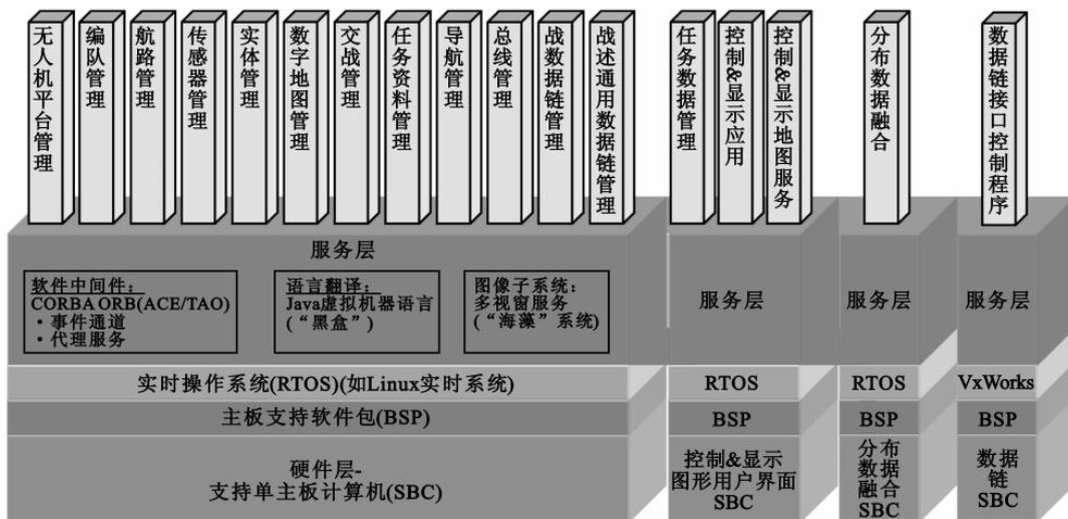
图 7 基于 CORBA 的有人机控制无人机的软件架构
