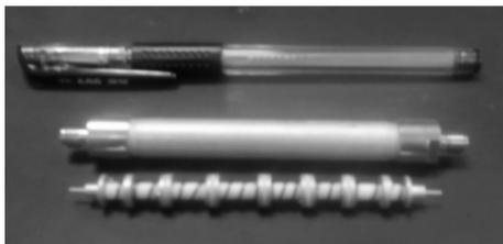
图 7 改进后的滤波器实物照片
